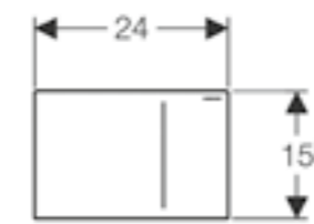
Geberit Sigma70 W 24 / D 0.4 / H 15.8cm For Sigma 12cm cistern.
